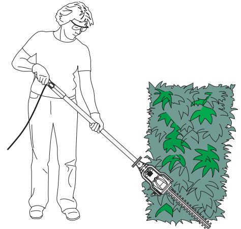
Figure 15 - Taille de la partie inférieure et des côtés des haies et des buissons
